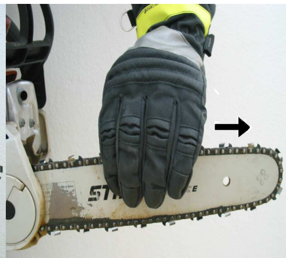
Sprawdzanie płynności ruchu łańcucha tnącego.
